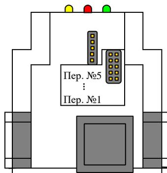
Рис. 3 Схема расположения переключателей настройки преобразователя
