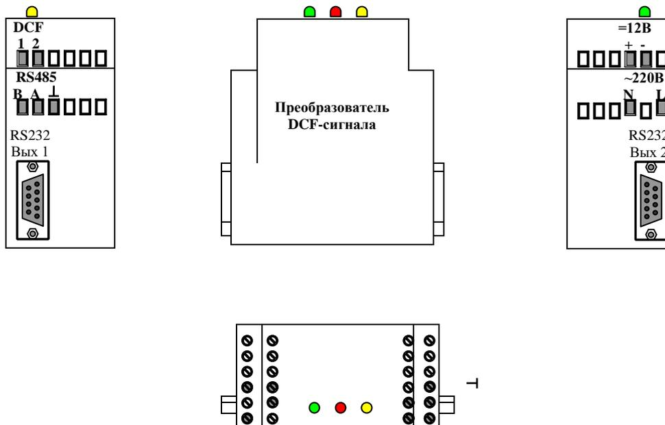
Рис. 1 Расположение разъёмов на корпусе преобразователя
