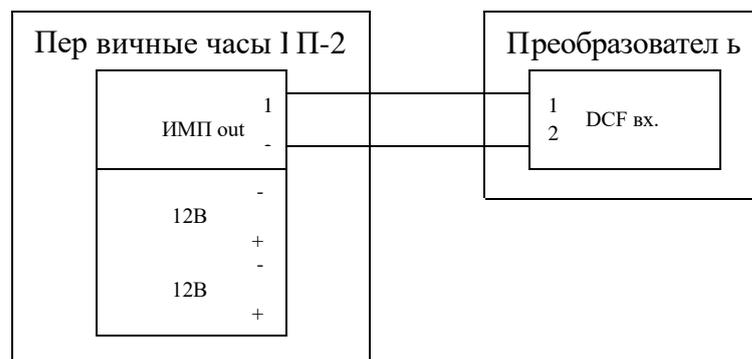
б) Пример подключения источника пассивного DCF-сигнала
